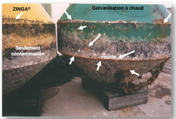
Conclusion de ce test: la bouée traitée au Zinga ne montrait aucune trace de rouille, mais celle galvanisée à chaud était sévèrement corrodée en plusieurs endroits.
